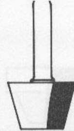
Kantenfräser, konisch wahlweise mit 7°, 15°, 30° und 45°
